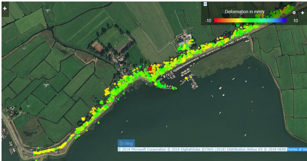
Figuur 28. Overzicht van satelliet metingen rondom de Durgerdammerdijk. De kleuren geven de gemiddelde daling per jaar weer (in mm)
